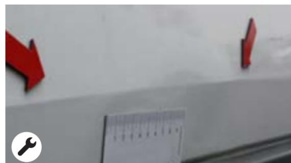
Defecto: Panel deformado a raíz de la reparación
