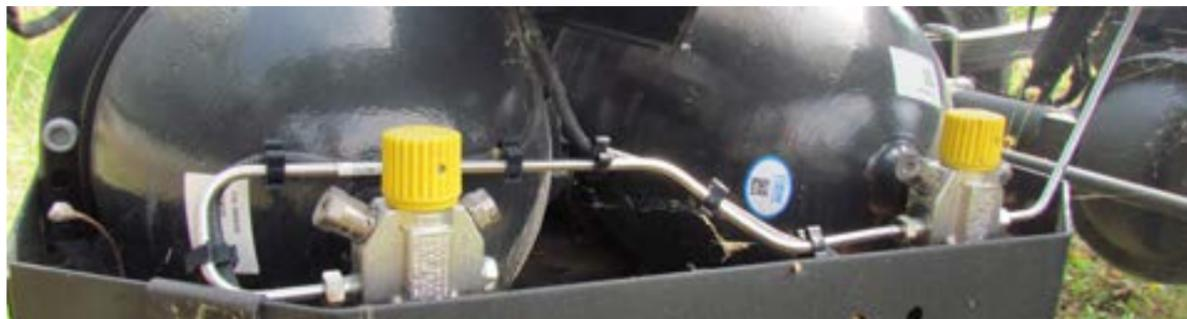
Las tuberías de conexión para las bombonas de GNC deben devolverse en condiciones adecuadas como se ilustra en las imágenes.
