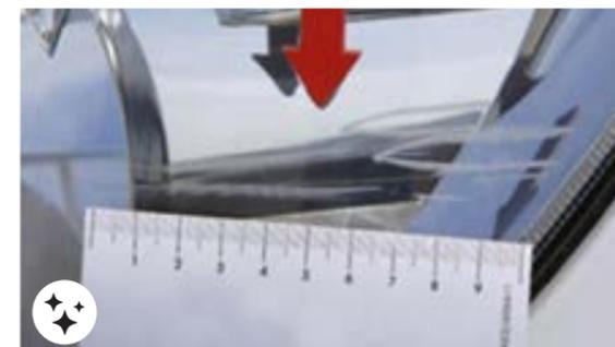
Fuertes arañazos (con levantamiento de material), fuera del campo de iluminación y del faro estanco
