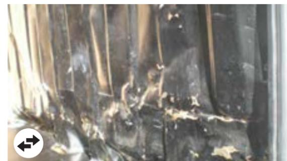
Deformaciones internas: Importante deformación, tiempo de reparación  $> 3$  h, perforaciones, cortes
