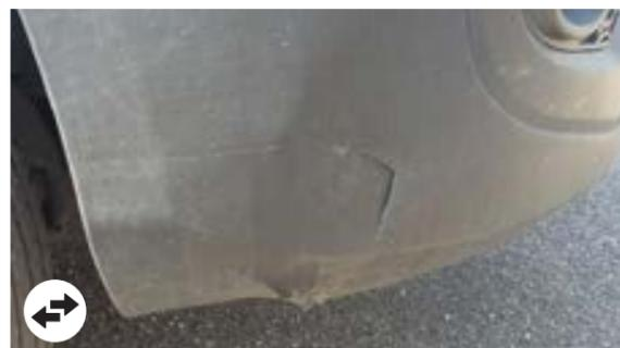
Rotura, levantamiento de material o deformación no reparable ni económica
