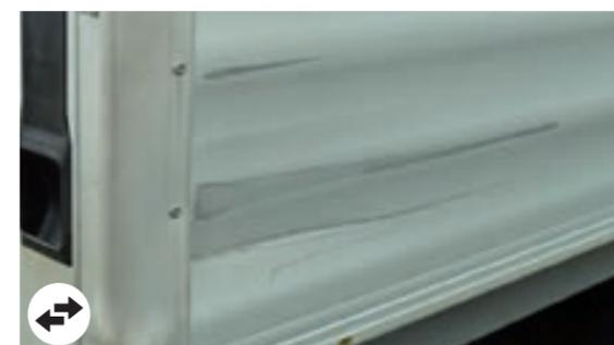
Deformaciones en los cierres del cuerpo si  $\geq 10$  cm, cierre no posible o no a prueba de arena
