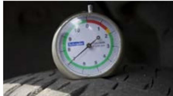
Neumáticos: Base de profundidad de la ranura  $\geq$  5 mm (CONFORME)
