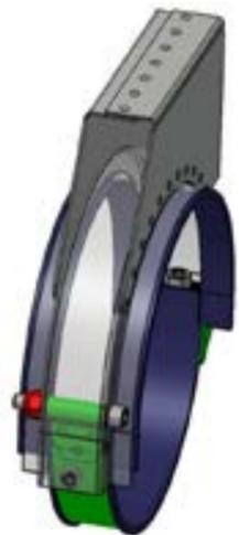
Sujeción de banda a soporte de tanque: verifique el estado de los componentes (oxidación, fatiga, etc.)
