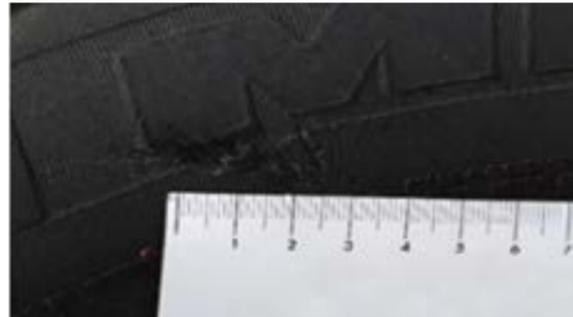
Neumáticos: Muesca  $\leq$  3 mm de profundidad (¿CONFORME?)
