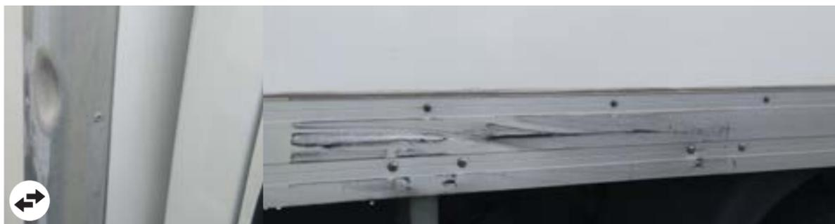
Perfiles laterales de los bajos de la carrocería: Deformaciones  $\geq$  10 cm
