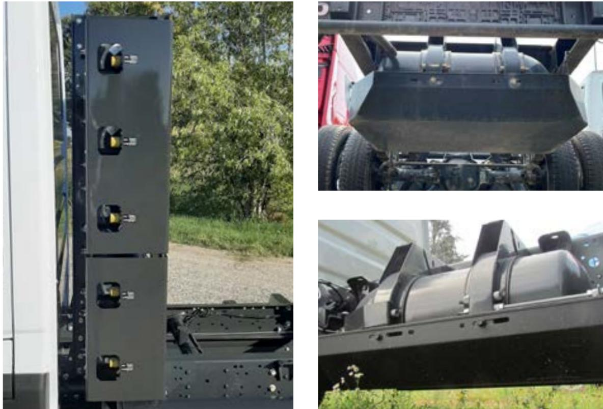
Las cubiertas protectoras de las bombonas de GNC deben devolverse en condiciones adecuadas, como se ilustra en las imágenes.
