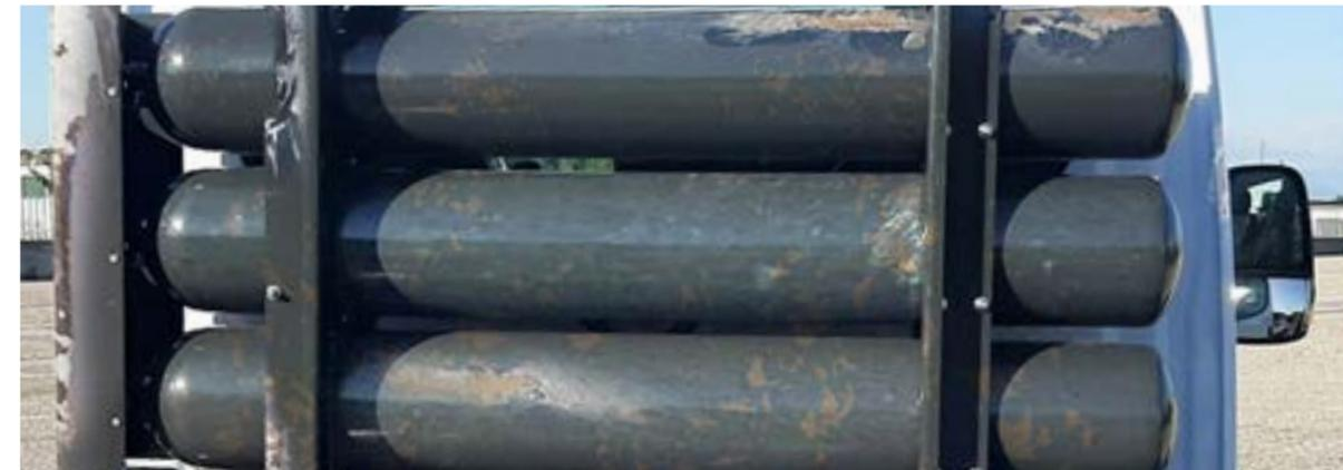
**Evidencia de reparaciones de las bombonas de GNC → carga para el reemplazo.**
