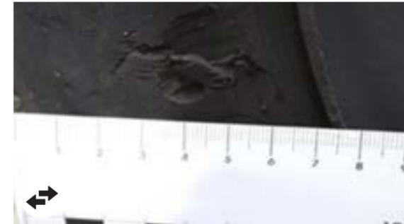
Neumáticos: Muesca  $>$  3 mm de profundidad, levantamiento de material
