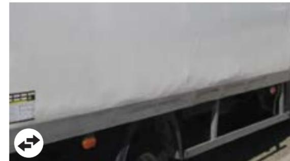
Paneles laterales de fibra: Deformación en la parte inferior; longitud  $>$  1 m
