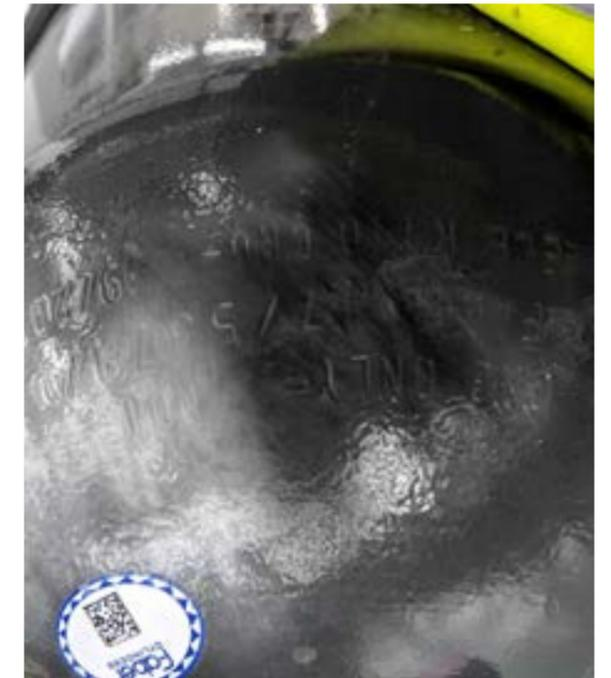
Marcas de identificación originales del depósito de GNL y de la bombona de GNC ausentes o ilegibles
