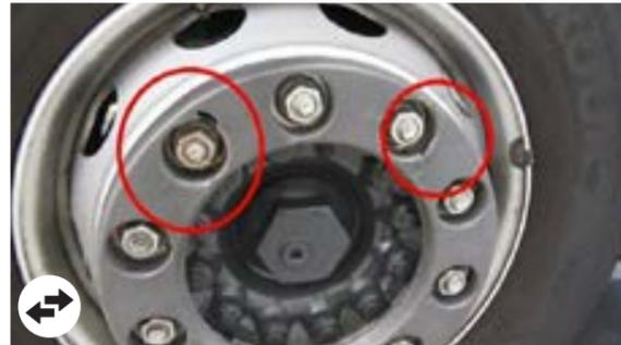
Tapacubos: Deformado, roto, falta material o está arrancado
