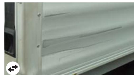
Deformación en los conductos que no merece la pena de reparar, no se puede efectuar el cierre o no es a prueba de arena
