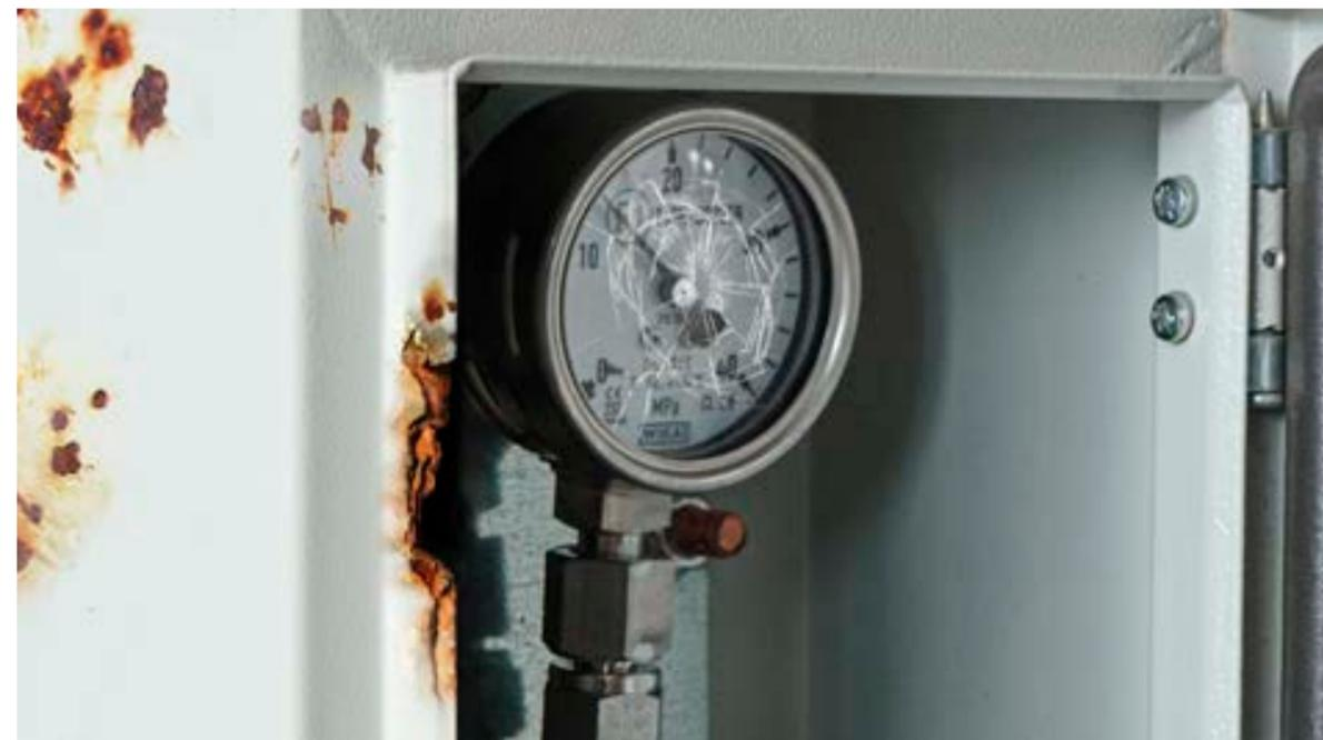
No está la llave del cárter de protección, receptáculo del GNC o manómetro dañados → cobro por sustitución del cárter completo.
