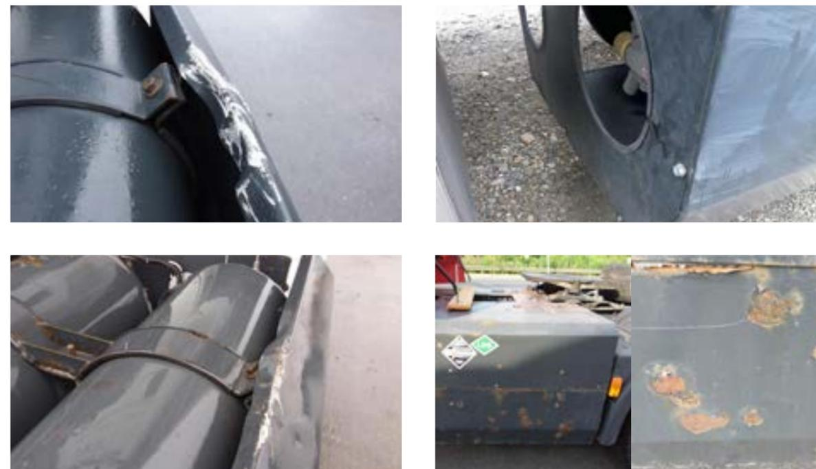
Abolladuras y deformaciones visibles que afectan al buen funcionamiento y/o a la seguridad
