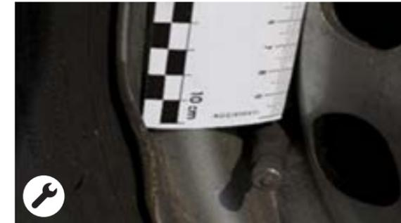
En llanta de acero: Borde de fijación ligeramente deformado
