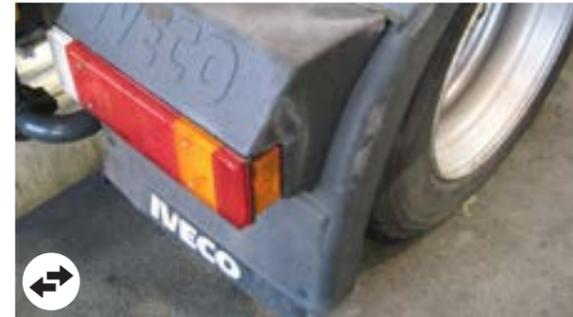
Marcas profundas y deformación
