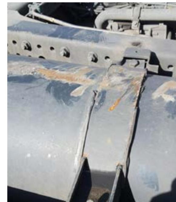
Oxidación, abolladuras, roturas y/o hendiduras → cobro por sustitución de los soportes y los aros.
